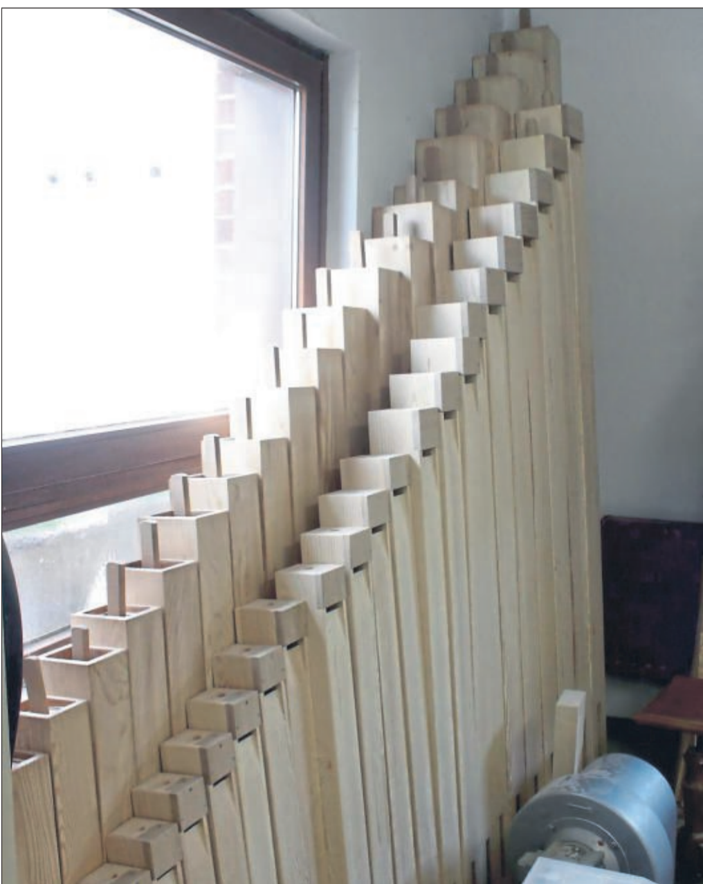
Eckensteher: Bereit zum Einbau stehen hier, angelehnt an die Außenwand der Orgelwerkstatt, zwei komplette Register der neuen Orgel für die Erlöserkirche.
