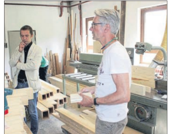
Quer verleimtes Holz wird für die großen Pfeifen verwendet. Schreinermeister Jürgen Drescher erklärte, weshalb das notwendig ist.
