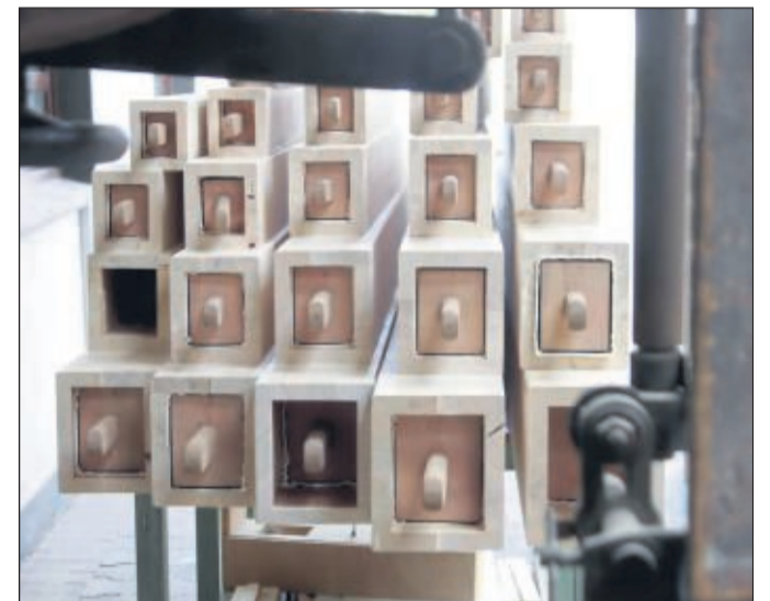
Stimmdeckel sind in diese Pfeifen eingesetzt. Hineinschieben oder Herausziehen erhöht oder senkt den Ton.
